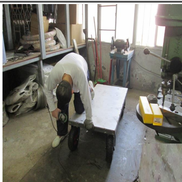
修繕舊有之推車台。
