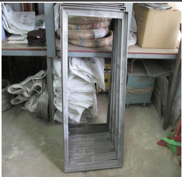
鋼材製作板車框架。
